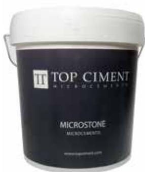
Microstone является двухкомпонентным отделочным микроцементом, созданным на основе гидравлического вяжущего вещества и специально отобранных микрочастиц и добавок. Microstone (А-компонент в виде порошка) смешивается с Acrisem (Б-компонент в виде жидкости), соблюдая при этом пропорции, указанные в техническом паспорте.
